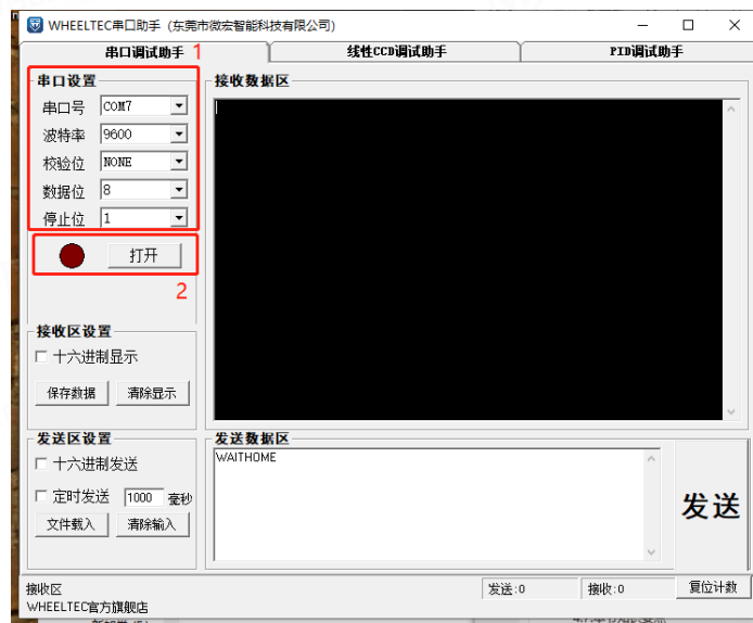
图 4-6-3 串口调试助手要设置的地方
