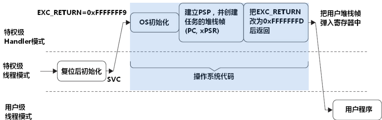
图 12.2 简单 OS 中的堆栈初始化
