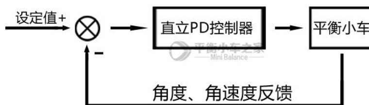
图5 平衡小车直立控制原理图
