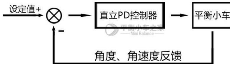
图1 平衡小车直立控制原理图
