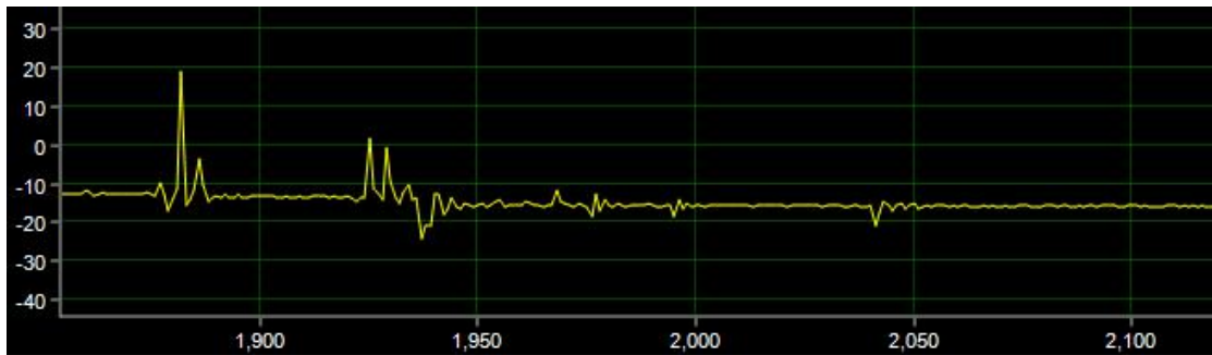
图4 MPU6050加速度计实际输出
