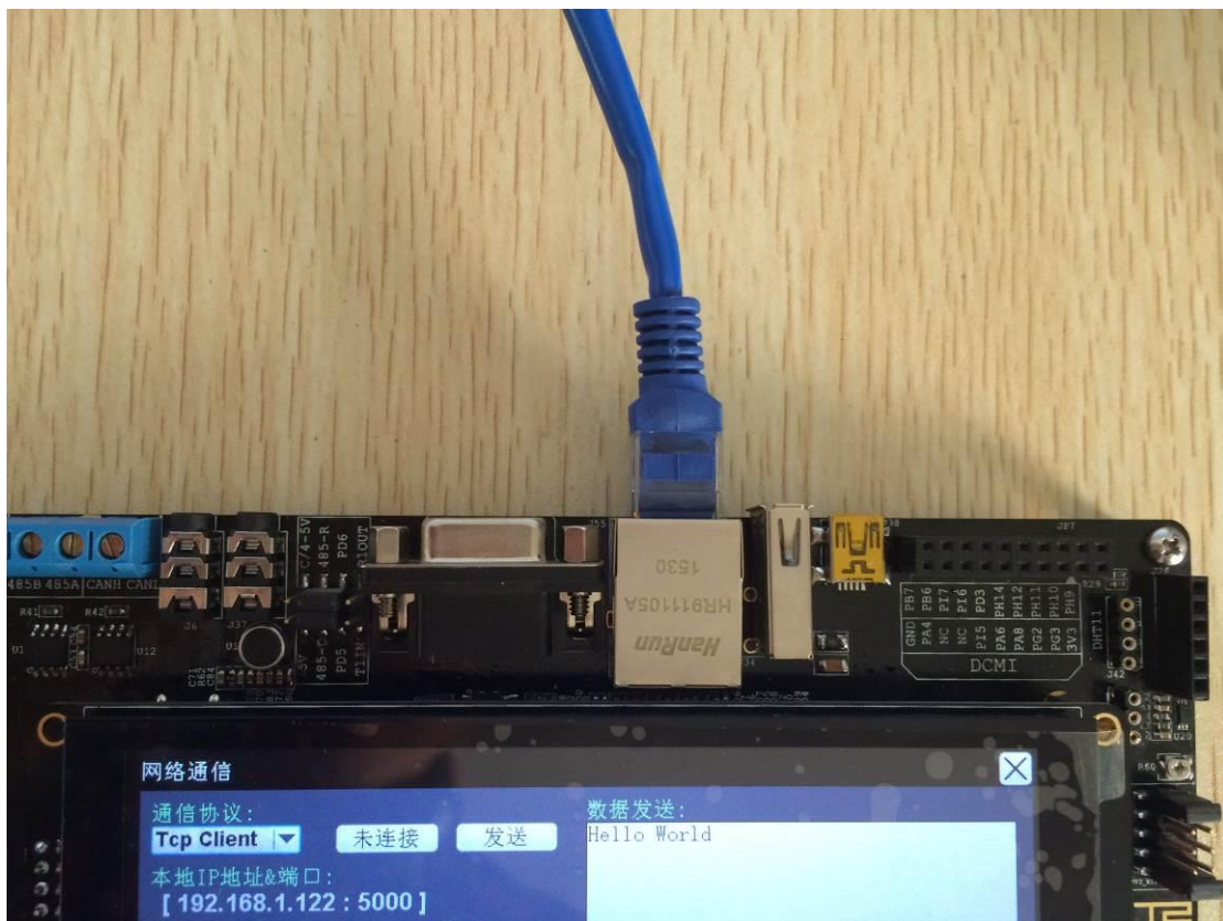
图 1-13 网线接在开发板上
